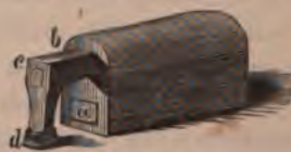
Fig. 225. Moufle pour l'extraction du zinc.
